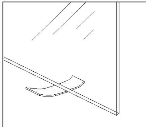
1. Prima della posa dei vetri fissi mettere sempre uno spessore in gomma trasparente spess 1-2 mm per tenerli sollevati dal pavimento.
