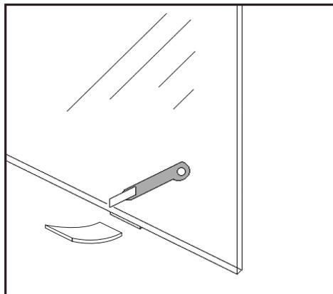
2. Controllare tutte le misure e i livelli, fissare il vetro con metalleria in dotazione poi procedere al taglio dello spessore a filo vetro su ambo i lati.
