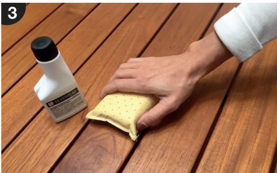
3. Procedere con il trattamento della pedana utilizzando SILVERPLAT OIL versandone una giusta quantità sul cuscinetto in pelle contenuto nel kit e distribuirlo lungo la venatura del legno, in modo continuo ed omogeneo, evitando interruzioni e cumuli di olio in eccesso.
