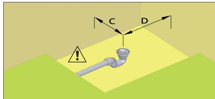
4. Rimuovere il piatto doccia filo pavimento e con l'ausilio delle misure annotate in precedenza collegare il sifone allo scarico fognario
