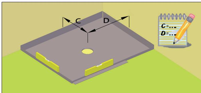
3. Posizionare a secco il piatto doccia filo pavimento assicurandosi che sia perfettamente in piano e che sia perfettamente aderente alle pareti. Annotare le distanze (C e D) intercorrenti tra il muro e il centro dello scarico del piatto doccia per il successivo montaggio del sifone.
