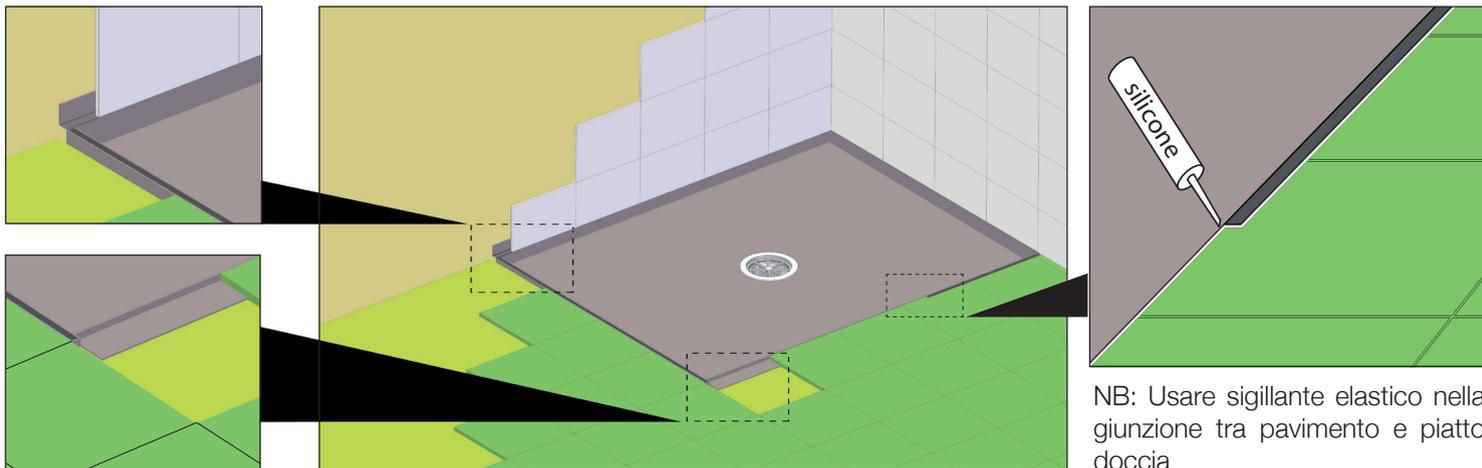
9. Posare le piastrelle del rivestimento come da dettaglio.
