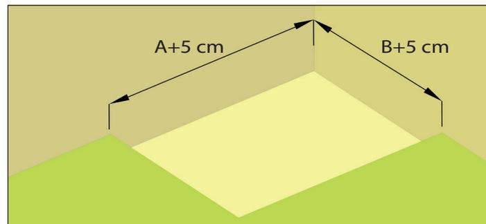
2. Praticare lo scasso del massetto aumentando le misure A e B di 4-5 cm (A+5 B+5) per agevolare il montaggio.
